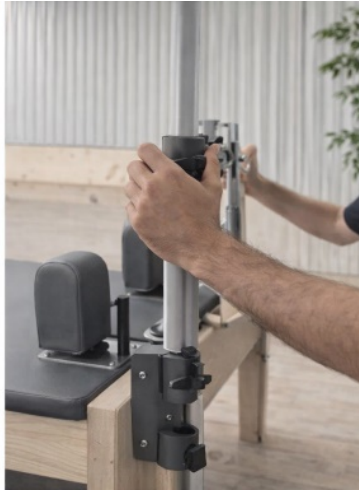
Abb. 3 — Stangen und Umlenkrollen am Rahmen befestigen
