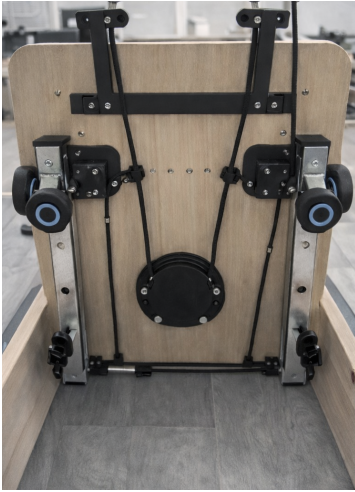
Abb. 9 — Schlitten in der Schiene und Federsteg darunter
