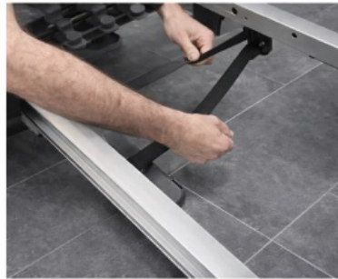
Abb. 4 — Seil durch die Umlenkrollen einfädeln
