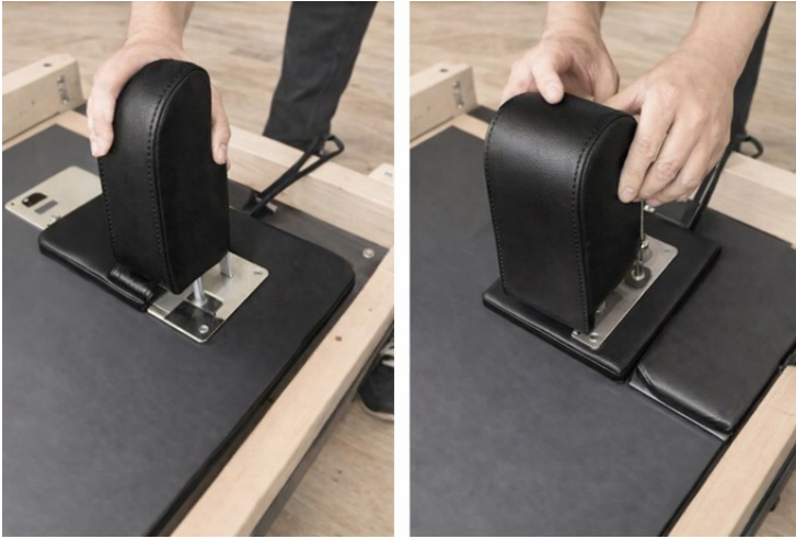
Abb. 2 — Schulterpolster auf den Schlitten setzen und ausrichten
