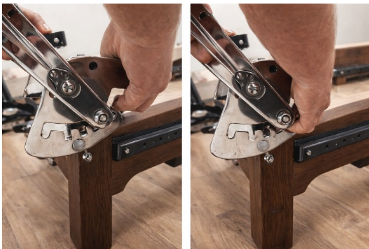
Abb. 7 — Fußstange auf der Reformerschiene festsetzen
