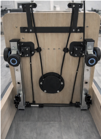
Abb. 8 — Schlitten in der Schiene und Federsteg darunter
