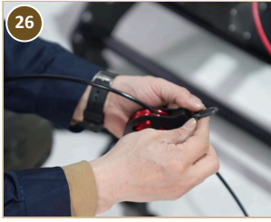
26 Pulley-Rad mit Karabiner verbinden
