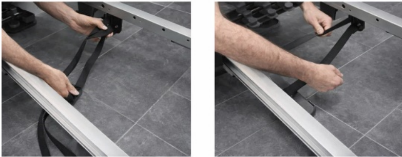
Abb. 4 — Seil durch die Umlenkrollen einfädeln
