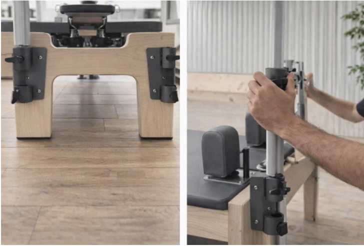
Abb. 3 — Stangen und Umlenkrollen am Rahmen befestigen
